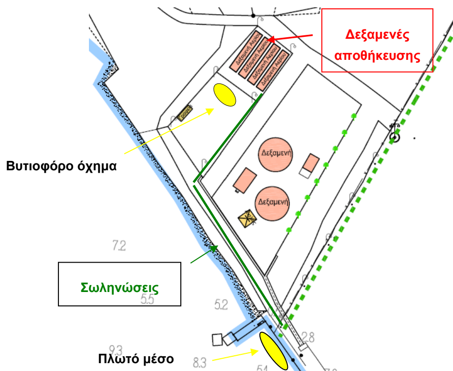
Εικόνα 8: Θέση του πλωτού μέσου και του βυτιοφόρου οχήματος κατά τη μετάγγιση αποβλήτων στις/από τις δεξαμενές.
